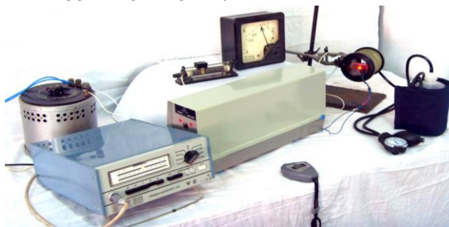
Рисунок 1 – Установка для исследования влияния магнитного поля на температуропроводность вещества методом лазерной вспышки в зависимости от давления при комнатной температуре (разработки проф. Сафарова М.М.)
