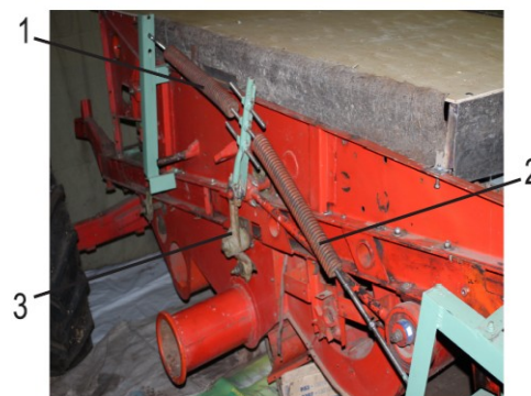
Рисунок 8 – Система рекуперации: 1 – пружина левая; 2 – пружина правая; 3 – двуплечий рычаг.
