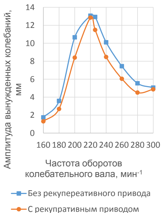
Рисунок 11 – Амплитудно-частотная характеристика экспериментальной установки (колебания в вертикальной плоскости в точке на уровне передних опорных колес) при q_n=9 кг/с
