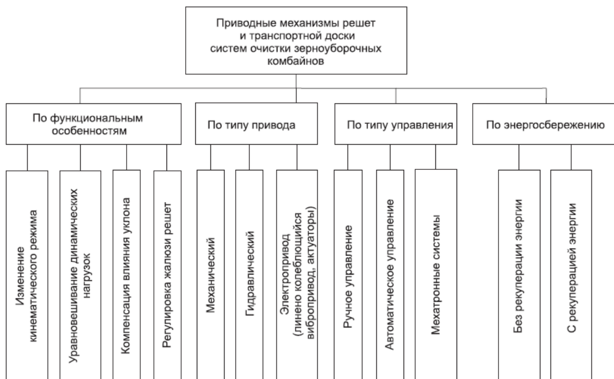
Рисунок 1 – Классификация приводных механизмов решет и транспортной доски систем очистки зерноуборочных комбайнов
