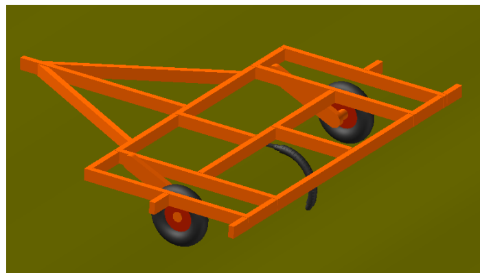
Рисунок 2– 3D модель культиватора в RecurDyn
