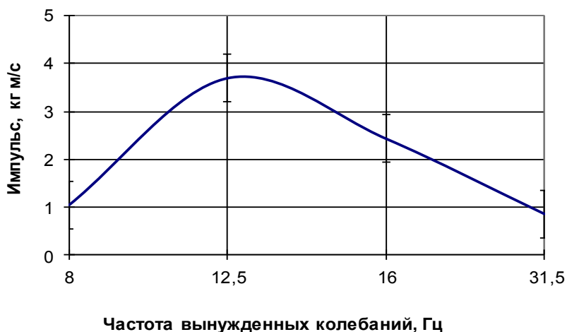
Рисунок 8 – Импульсно-частотная характеристика рабочего органа со стойкой в виде гибкого трубчатого элемента
