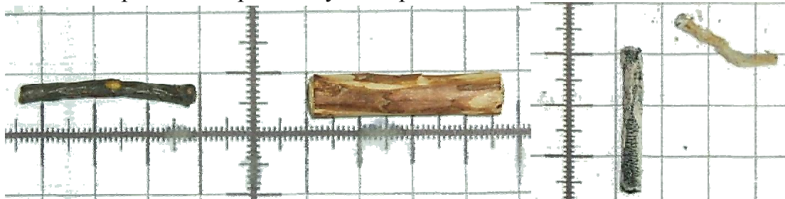
Рисунок 5 – Образцы древесины, исходные слева и после нагрева справа (шкала в мм)
