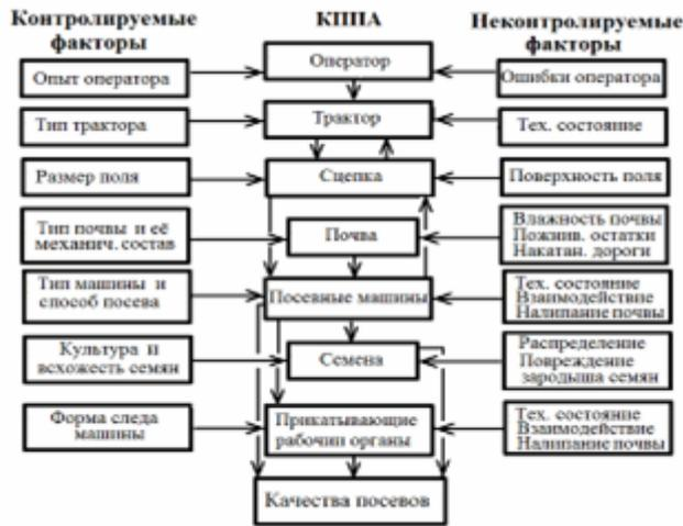
Рисунок 1 – Схема влияния факторов на эффективность функционирования КППА
