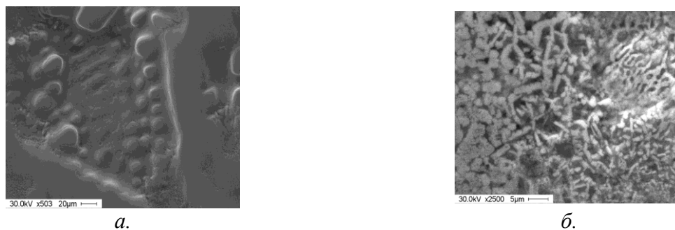
Рисунок 4 – Микроструктура боридного покрытия типа I, полученного на стали 65Г с использованием ТВЧ-нагрева в отраженных электронах
