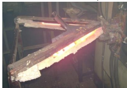
Рисунок 7 – Борирование с использованием ТВЧ-нагрева СЛ типа 3, предназначенной для установки на ПК-9,7 «Кузбас»
