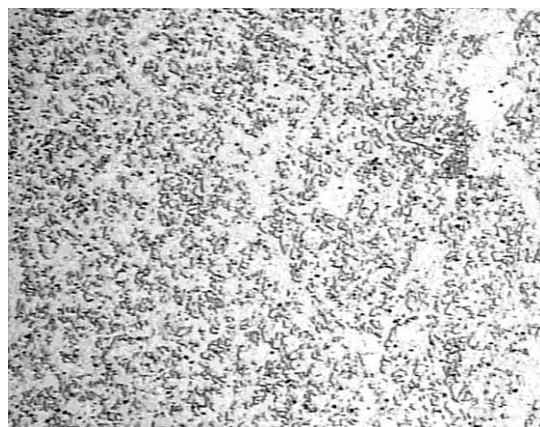
Рис. 4. Микроструктура наплавленного металла опытным электродом №1
