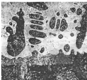
Рис. 23. Зона сплавления борированного твердого сплава (ПГ-С27) и стали 65Г (x300)
