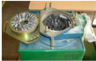
Рисунок 34 – Экспериментальный измельчитель с предлагаемыми рабочими органами (Патенты № 65401, 64942)
