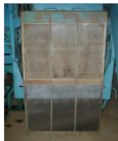
Рисунок 33 – Предлагаемые решёта, установленные в решетном стане модернизированной зерноочистительной машины МС-4,5
