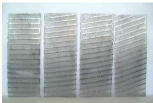
Рисунок 33 – Предлагаемые решёта, установленные в решетном стане модернизированной зерноочистительной машины МС-4,5
