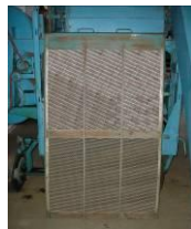
Рисунок 33 – Предлагаемые решёта, установленные в решетном стане модернизированной зерноочистительной машины МС-4,5
