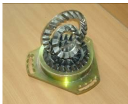
Рисунок 34 – Экспериментальный измельчитель с предлагаемыми рабочими органами (Патенты № 65401, 64942)
