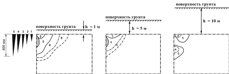
Рисунок 4 – Влияние глубины погружения индентора на НДС области
