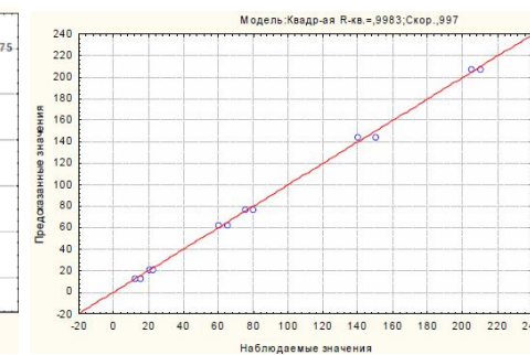
Рисунок 3 – Корреляционная кривая наблюдаемых (экспериментальных) и предсказанных (расчетных) значений толщины диффузионного слоя
