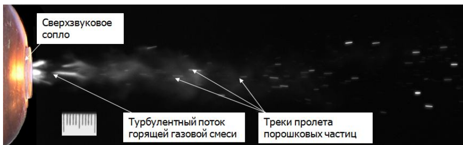
Рисунок 9 – Турбулентный сверхзвуковой газопорошковый поток
