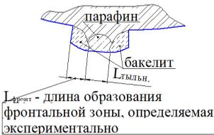
Рисунок 7. Схема комбинированной пропитки выступов ПШК
