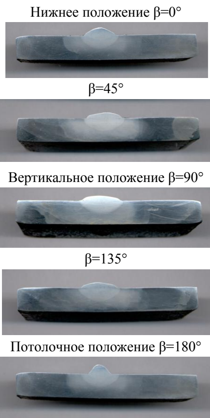
Рис. 11 Изменение геометрии наплавленного валика в зависимости от:
