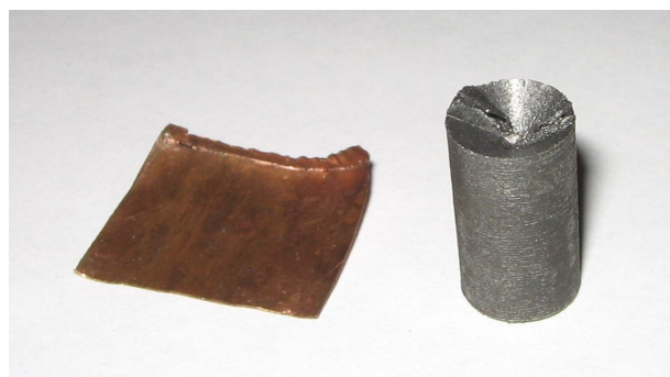
Рисунок 4 – Образец для сверления. а) – схема образца: 1 – тело образца, 2 – стержень, 3 – медная фольга, 4 – спиральное сверло, б) – медная фольга после распрессовки
