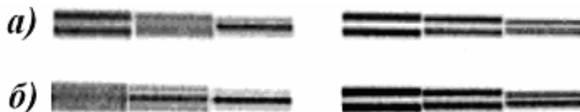
Рис.11. Изображение штрихов на экране монитора: а) - допустимый размах вибрации; б) - размах вибрации превышает допустимый
