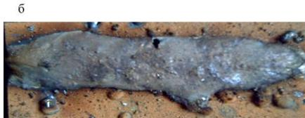
Рис. 10. Сформированное покрытие после наплавки
