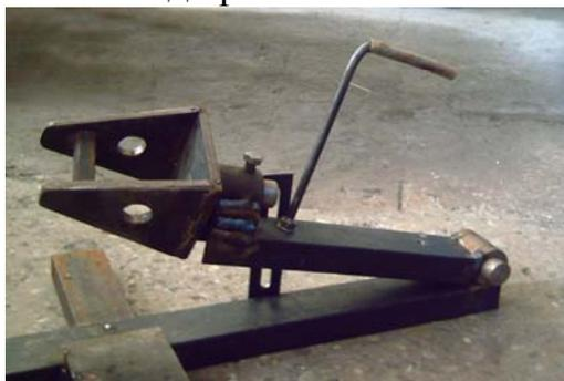
Рис. 21 Вспомогательное оборудование для наплавки зубьев ковшей экскаваторов
