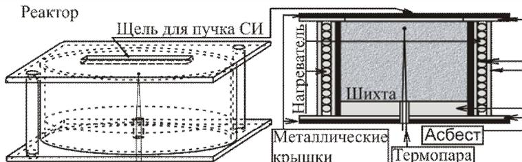
Рис. 3 Схема специализированного экспериментального реактора для проведения исследования с использованием метода дифракции СИ.
