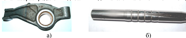
Рисунок 12 - Коромысло клапана механизма газораспределения дизельных двигателей (а), дорт для обработки коромысла (б)
