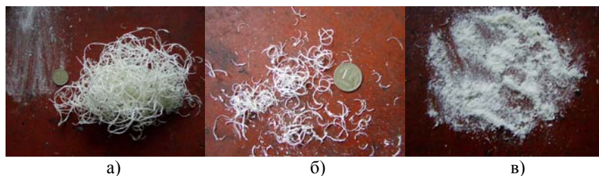
Рисунок 2 – Виды образующейся стружки при точении стеклопластика: а – сливная, б – элементная, в – пылевидная
