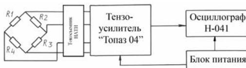
Рис. 4. Схема одного тензочанала
