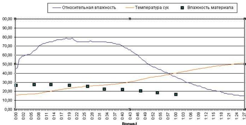
Рис. 4. Кривые температуры, влажности осушающего агента и кривая сушки материала.
