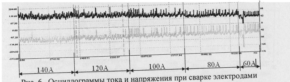
Рис. 6. Осциллограммы тока и напряжения при сварке электродами ЦУ-5, показывающие изменение количества коротких замыканий дугового промежутка в зависимости от величины  $I_{ce}$ .
