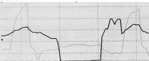
Рис. 8. Осциллограмма  $I_{cb}$  показывающая кратковременные провалы тока до нуля, снижающие физическую устойчивость процесса сварки непосредственно после основного импульса - 1 и дополнительного импульса - 2
